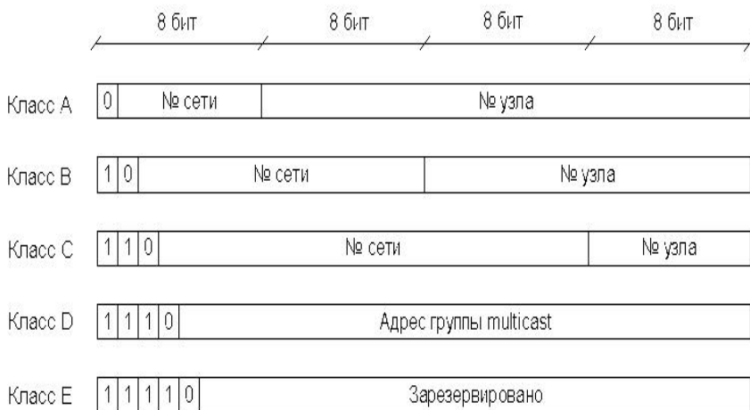
Рис. 14. Классы IP-адресов в двоичной системе
