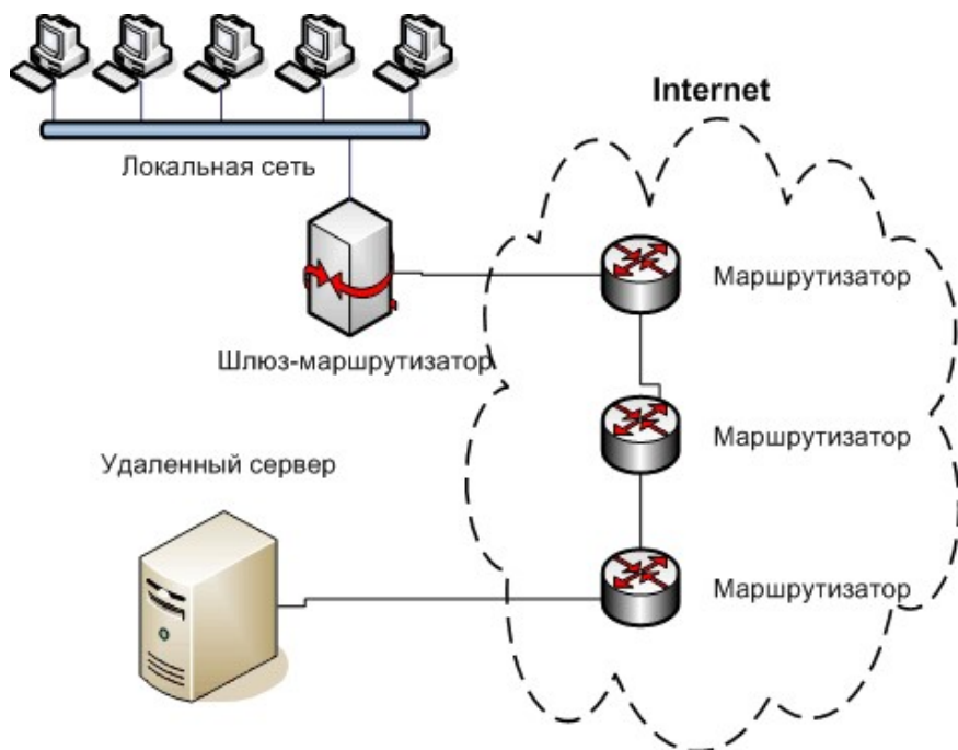
Рис. 18. Схема объединения ЛВС и Internet
